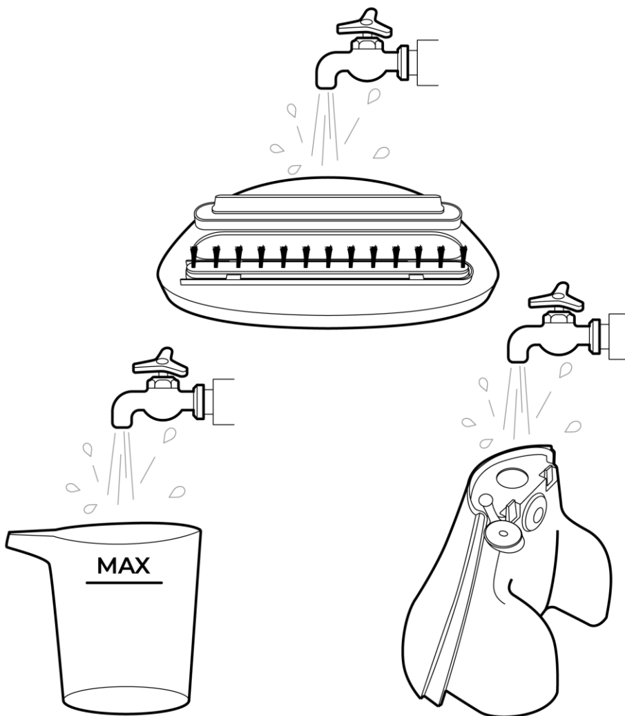
Figura 19 – Curățarea rezervorului de apă și a accesoriilor
